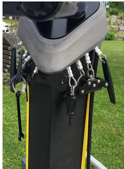
Die Ausstattung dieser Service-Stationen reicht von einer Aufhängevorrichtung und einer Luftpumpe bis zu hilfreichen Werkzeugen und Reifenheber. Damit bietet sich für Radler:innen die Möglichkeit, kleinere Pannen selbst zu reparieren und für Verkehrs- und Betriebssicherheit bei den Bikes zu sorgen. Ein QR-Code an der Service-Station liefert
